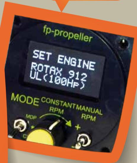
Cuore del dispositivo è un microcontrollore (CPU) di ultima generazione, che opera con l'obiettivo di mantenere costanti i giri del motore. Il software realizzato legge i segnali dei sensori, elabora i dati e decide, su questa base. Per svolgere così velocemente questo processo, il software è costituito da diversi blocchi, ognuno dei quali opera autonomamente in parallelo agli altri.
