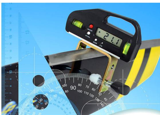
È ben noto ai piloti che differenze di angolo di passo tra le pale dell'elica sono causa di vibrazioni. Per questo, nelle eliche regolabili a terra, l'angolo di passo delle diverse pale deve essere regolato con la miglior precisione al valore corretto.
