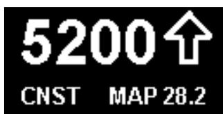
Il valore mostrato nel display OLED è il valore di **RPM Target**, il sistema ha un isteresi di  $\pm 100$  rpm per evitare inutili sollecitazioni al servomotore dell'elica, quindi il valore di RPM reali potrebbe differire di  $\pm 100$  rpm
