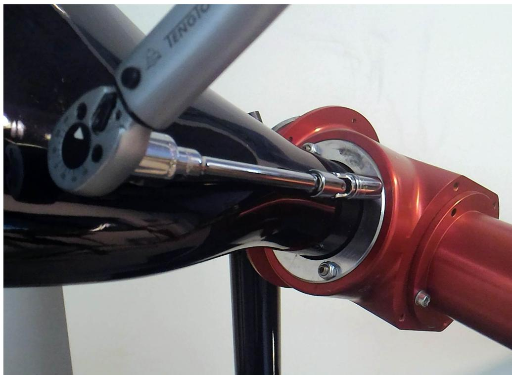
Una volta completata l'operazione di serraggio pale, consigliamo di marcare con vernice (Es. CrossCheck Torque Seal) la posizione angolare della ghiera rispetto al mozzo e anche la posizione dei dadi autobloccanti.
