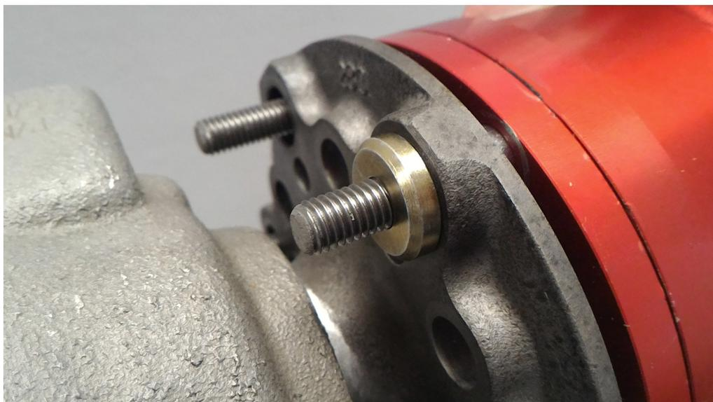
c) Inserire i dadi autobloccanti alla base del mozzo. Stringere il dado sul lato posteriore della flangia. Procedere in modo incrociato, stringendo gradualmente fino a tirare completamente la base della flangia del mozzo. Stringere le viti con una coppia di 2 kg \* m.
