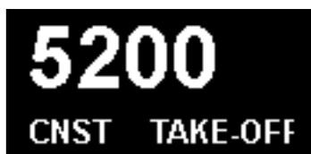
Una volta superati i 5000 RPM e per 3 minuti (nel caso di motori Rotax), il sistema aggiunge un offset di +300 RPM al target calcolato (MDP) o impostato dal pilota (CNST), in modo da poter raggiungere i 5800 RPM per la fase di decollo.
