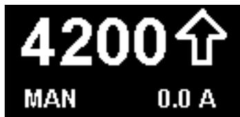
Il display indica gli **RPM reali** e, durante il movimento dell'elica, il consumo di corrente del servomotore dell'elica, utile come diagnostica del corretto funzionamento del sistema.
