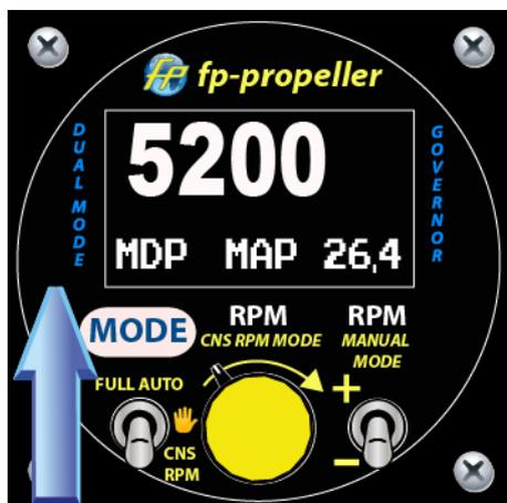
In questa modalità il sistema regola il passo in modo completamente automatico sulla base della curva MDP-RPM TARGET inserita nel microcontrollore per il motore selezionato.
