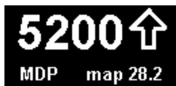
Il valore mostrato nel display OLED è il valore di RPM Target, il sistema ha un isteresi di  $\pm 100$  rpm per evitare inutili sollecitazioni al servomotore dell'elica, quindi il valore di RPM reali potrebbe differire di  $\pm 100$  rpm
