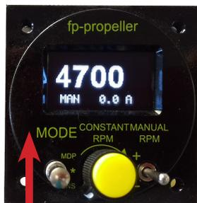
In questa modalità il sistema regola il passo in modo completamente automatico sulla base della curva MDP-RPM TARGET inserita nel microcontrollore per il motore selezionato.
