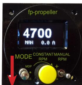
In questa modalità, il pilota decide i giri target ruotando il potenziometro (B) e il governor muove il passo dell'elica per raggiungere tale valore target.
