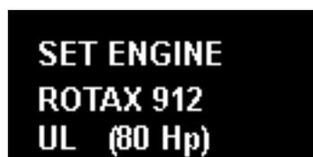
Ad ogni pressione dell'interruttore (C) **verso l'alto** per almeno 1 sec. cambia il motore selezionato.
