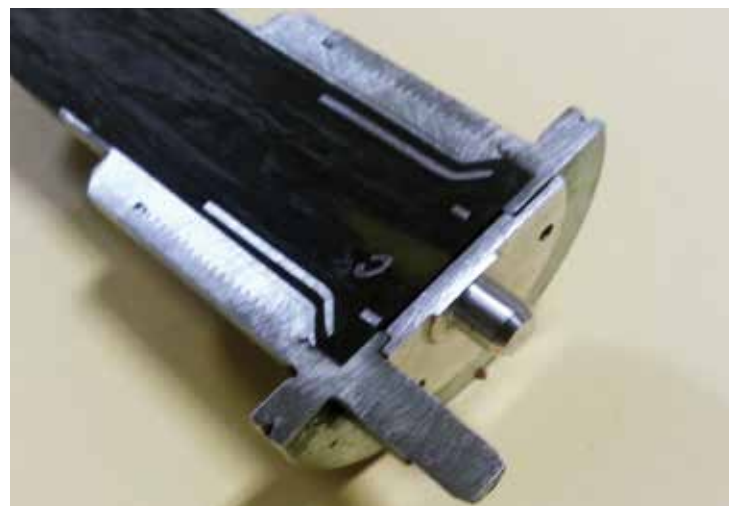
fig. 1 es. di ancoraggio pale nelle eliche FP-propeller. Pala Warp Drive
