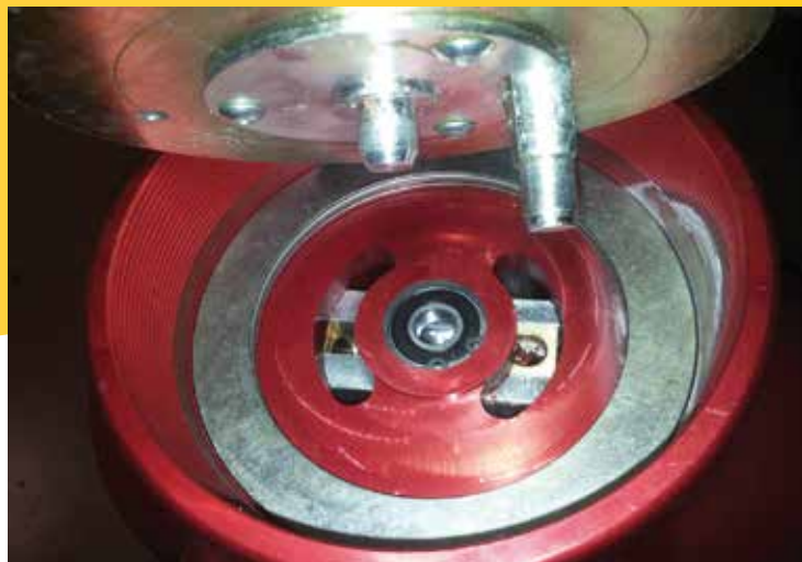
fig. 2 Operazione di inserimento della pala nella rispettiva sede
